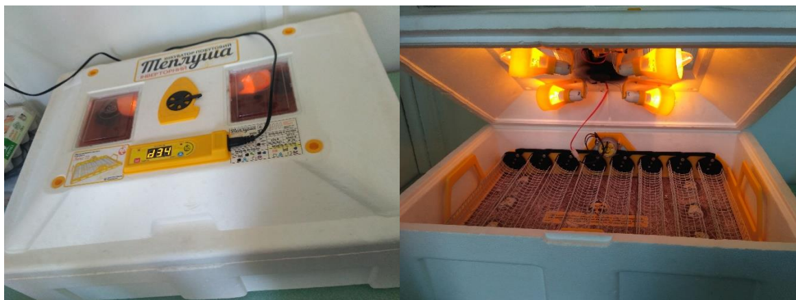
Рис. 2.1 Вигляд інкубатора, що був використаний у методиці визначення подразнювальної дії ГКБ на ХАО 9-денних курячих ембріонів
