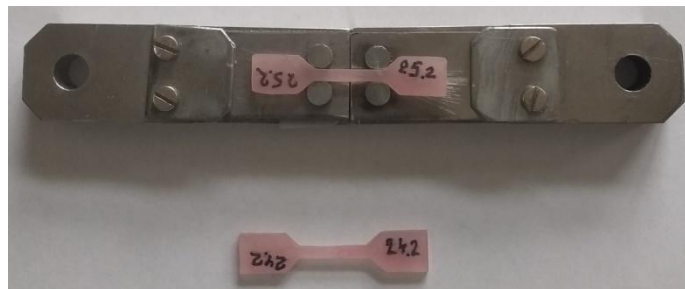
Рис. 2.4 Вигляд встановленого в пристосування зразка для експериментів на розтяг
