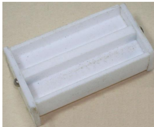
Рис. 2.2 Загальний вигляд форм для виготовлення призматичних (зверху) та циліндричних зразків стоматологічних полімерів
