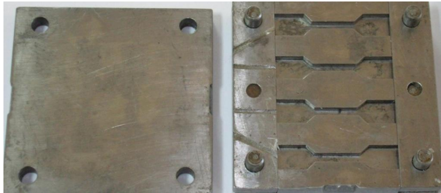
Рис. 2.1 Конструкція прес-форми (а) для виготовлення пластинчастих зразків зі стоматологічних полімерів та її загальний вигляд (б)
