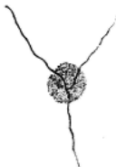
Fig. 6. Fissurenbildung am Oberschenkelknochen vom Ochs bei schrägem Auftreffen, Schwarzpulver, glatter Lauf, 14 n.
